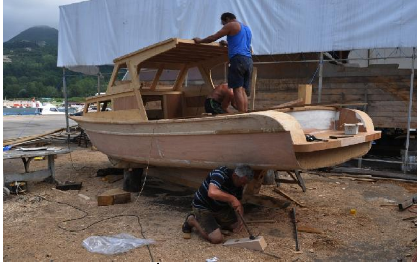
Fotoğraf 19. Kurucaşile İlçesi Merkez-Hasan Büyükböcek Atölyesi-Yapımı bitmek üzere olan bir gezinti teknesi (AEGM Arşivi)
