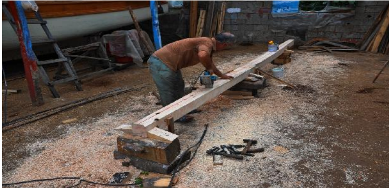
Fotoğraf 15. Kapısıyu Köyü-Mustafa Tok Atölyesi-Omurganın yapımı (AEGM Arşivi)
