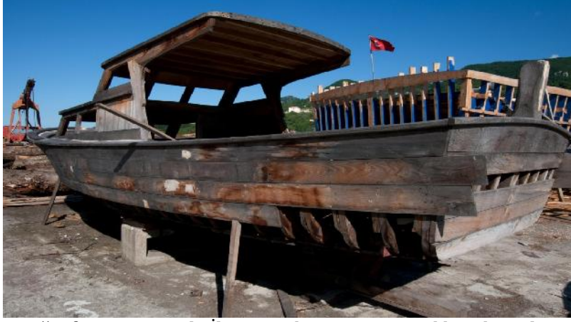
Fotoğraf 18. Kurucaşile İlçesi Merkez-Hasan Büyükböcek Atölyesi- Dış sargısı yapılmakta olan bir gezinti teknesi (AEGM Arşivi)
